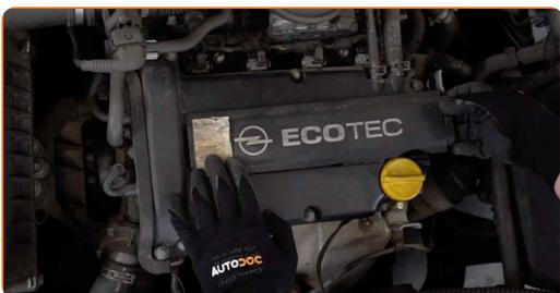
**3** Desconecte o conector da bobina de ignição. Use uma chave de fenda plana.
