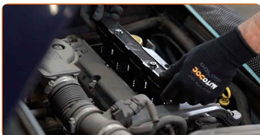
**8** Apertar a fixação da bobina de ignição. Use Torx T30. Use uma chave de torque. Aperte-o para o torque de 15 Nm.
