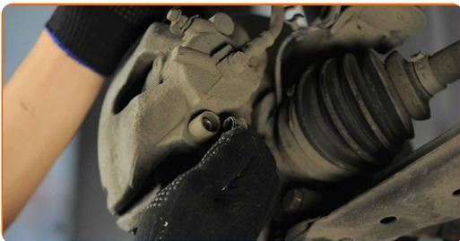
**9** Limpe os elementos de fixação da pinça de travão. Use uma escova metálica. Use spray WD-40.
