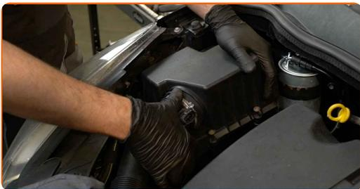
**15** Aparafusar os parafusos de fixação da tampa do filtro de ar. Use Torx T20. Use uma chave de catraca.
