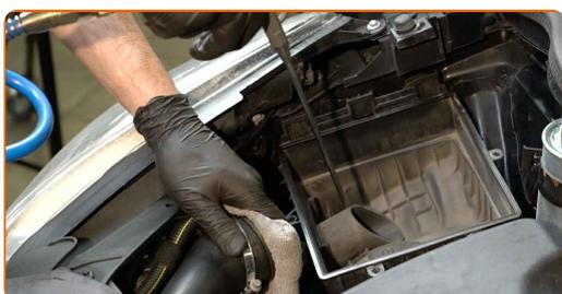
Substituição: filtro de ar – VAUXHALL Corsa Mk III (D) Hatchback (S07).
