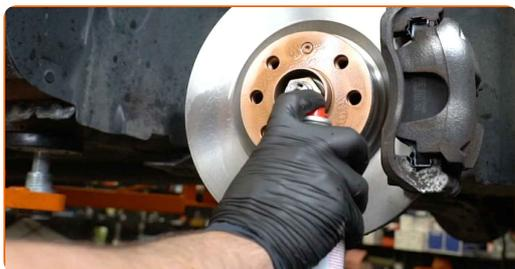
Substituição: discos de travão – VAUXHALL Corsa Mk III (D) Hatchback (S07).
