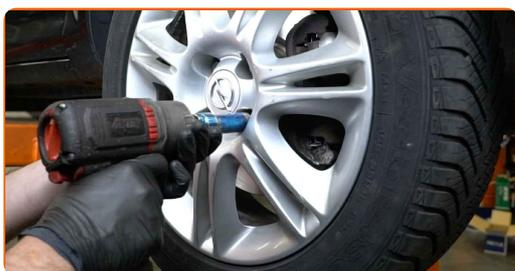
**35** Baixar o carro e trabalhar em ordem transversal, apertar os parafusos das rodas. Use o soquete de impacto para roda #17. Use uma chave de torque. Aperte-o para o torque de 110 Nm.
