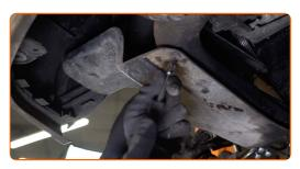
Trate a superfície onde o disco de travão entra em contacto com o aro da roda. Use massa de cobre.
