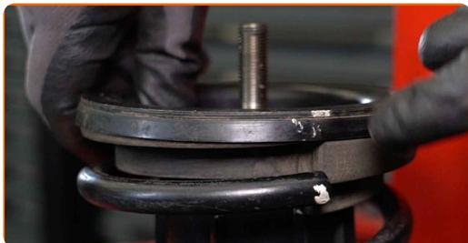
**33** Aperte a porca do suporte do amortecedor da haste do pistão. Use HEX n.º H5. Use uma chave soquete n.º 19. Use uma chave de torque. Aperte-o para o torque de 55 Nm.
