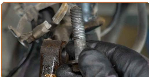
**16** Desligar a manga de eixo do suporte do amortecedor.
