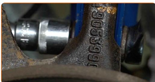
**43** Aperte os fixadores inferiores que conectam a coluna de suspensão à manga de eixo. Use uma chave combinada nº 18. Use uma chave soquete nº 18. Use uma chave de torque. Aperte-o para o torque de 90 Nm.+45°+15°
