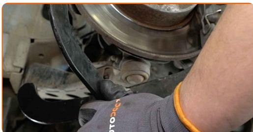
**14** Desaparafuse os fixadores que ligam o suporte de suspensão à manga de eixo. Use uma chave combinada nº 18. Use uma chave soquete nº 18. Use uma chave de catraca.
