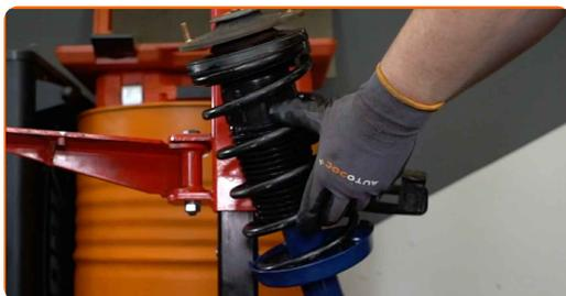
**37** Limpe os assentos de montagem da coluna do amortecedor.
