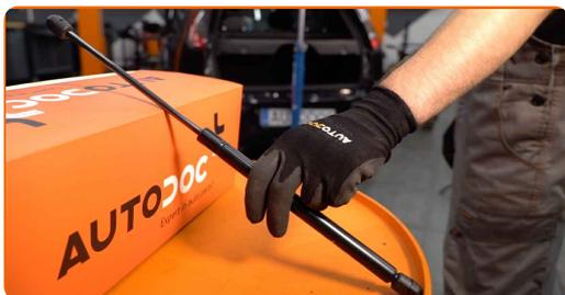
Substituição: amortecedor da mala – VAUXHALL Corsavan Mk II (C) (X01).
