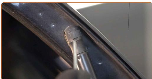
**4** Solte o anel de retenção que liga o amortecedor a gás à carroçaria do automóvel. Use uma chave de fenda plana.
