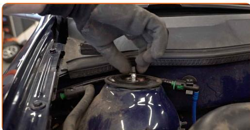
Substituição: cabeçotes do amortecedores – VAUXHALL Corsavan Mk II (C) (X01). Conselho da AUTODOC:
