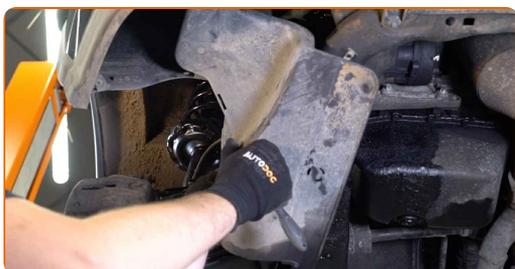
**31** Instale e aperte os elementos de fixação da cobertura do arco da roda. Use Torx T20.
