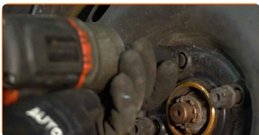
**37** Baixar o carro e trabalhar em ordem transversal, apertar os parafusos das rodas. Use uma chave de torque. Aperte-o para o torque de 110 Nm.
