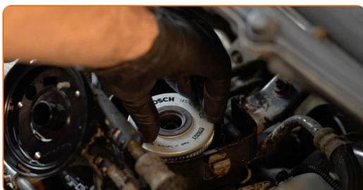
**Substituição: filtro de combustível – VAUXHALL Frontera Mk II (B) SUV (U99).
