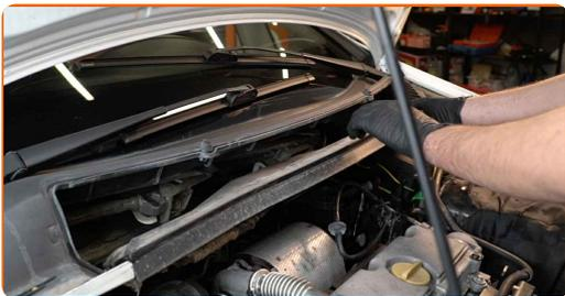
**23** Aparafuse os fixadores da parte inferior do painel frontal. Use uma chave soquete nº 10. Use uma chave de catraca.
