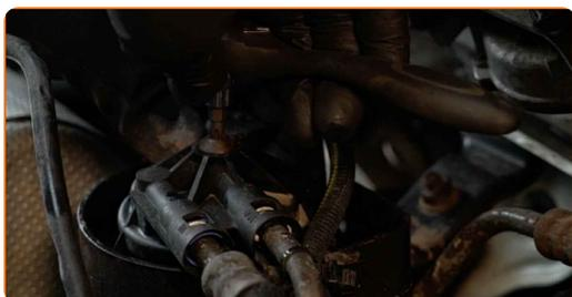
**21** Conecte o conector do sensor de pressão do combustível.
