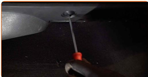
**24** Aperte os elementos de fixação do painel lateral do lado do passageiro. Use uma chave de fenda plana.
