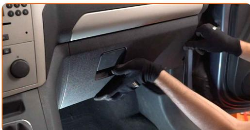
**21** Aparafuse os parafusos de fixação do porta-luvas. Use Torx T20.
