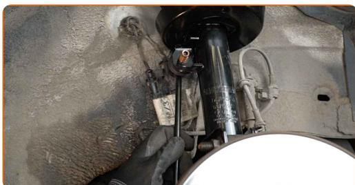
**13** Aperte o fixador da bieleta da barra estabilizadora. Use uma chave combinada nº 18.
