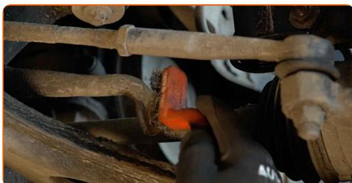
**12** Instale o terminal do estabilizador transversal.
