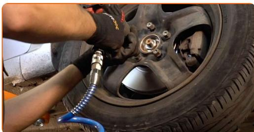
**40** Baixar o carro e trabalhar em ordem transversal, apertar os parafusos das rodas. Use uma chave de torque. Aperte-o para o torque de 110 Nm.
