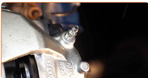
**34** Aperte o parafuso de purga da pinça de travão. Use uma chave soquete nº 8. Use uma chave de torque. Aperte-o para o torque de 11 Nm.
