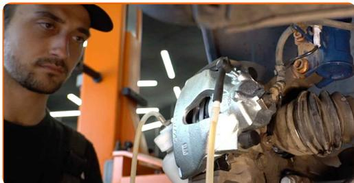
**31** Purgue o sistema da pinça de travão. Sem ligar o motor, pressione o pedal do travão várias vezes até sentir uma resistência significativa.
