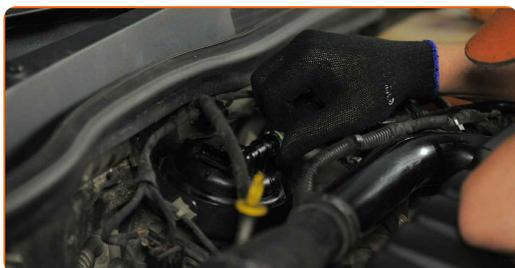
**17** Conecte o conector do sensor de pressão do combustível.
