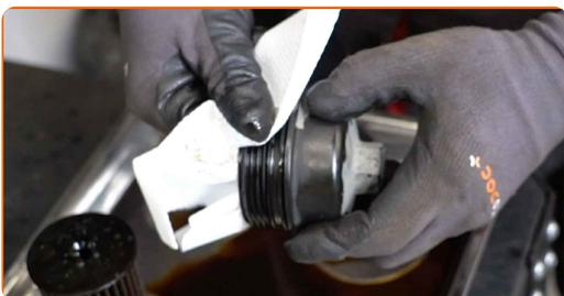
**17** Instale um novo anel O-ring no seu assento de montagem na tampa do filtro.
