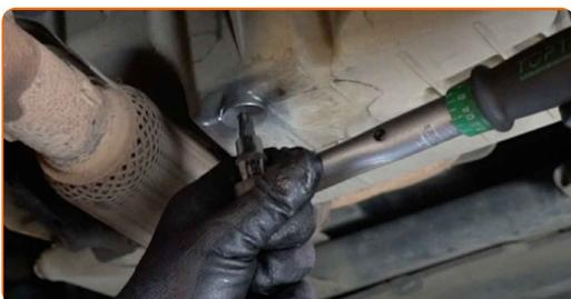
**21** Limpe a área do orifício de drenagem do cárter. Use o spray de limpeza universal.
