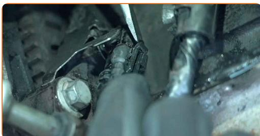
**4** Pressionar a mola de retenção do sensor de posição da cambota. Utilizar uma alavanca de montagem.
