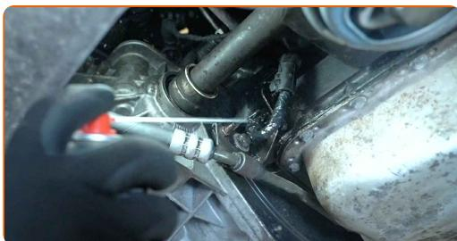
**3** Desligar o conector do sensor de posição da cambota. Utilizar uma alavanca de montagem.
