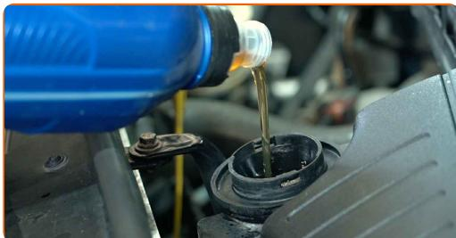
**Substituição: óleo do motor e filtro – VAUXHALL Movano Mk1 (A) Van (X70).**
