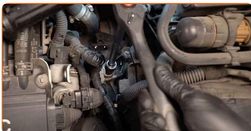
**22** Insira o funil. Coloque fluido da transmissão novo na caixa de velocidades através da entrada do respiradouro. Quantidade necessária de óleo: 1.6 l.
