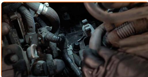
**20** Limpe o respiradouro da caixa de velocidades. Use o spray de limpeza universal.
