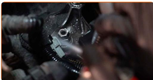
**21** Desaperte o respiradouro da caixa de velocidades. Use uma chave soquete nº 16. Use uma chave de catraca.
