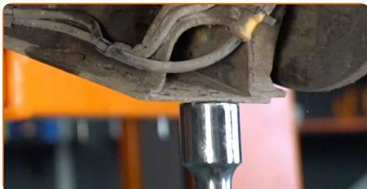
**23** Aparafuse o fixador inferior do amortecedor. Use uma chave soquete nº E14.
