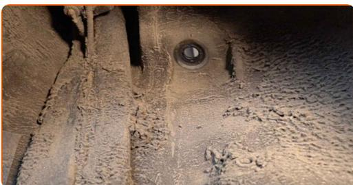
**19** Coloque o amortecedor no arco da roda e fixe-o.
