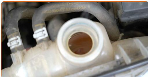
**46** Coloque a tampa do depósito do líquido de refrigeração.
