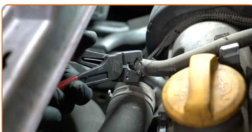
**22** Separe a mangueira do líquido de refrigeração. Use uma chave de fenda plana.
