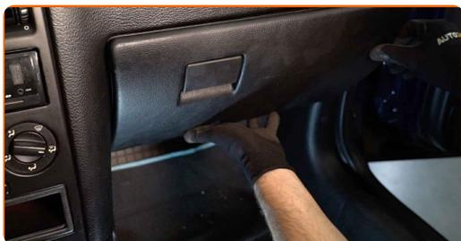
**15** Aparafuse os parafusos de fixação do porta-luvas. Use Torx T20.
