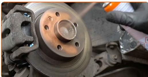
**25** Limpe a superfície do disco de travão. Utilize um produto de limpeza para travões.
