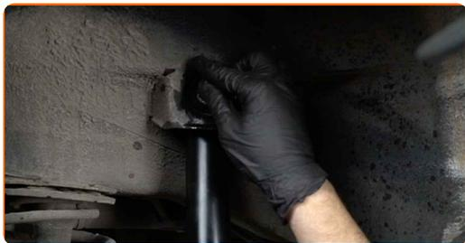
**16** Aperte o fixador superior do amortecedor. Use uma chave soquete nº E18. Use uma chave de catraca.
