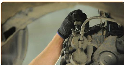
**29** Trate a superfície onde o disco de travão entra em contacto com o aro da roda. Use massa de cobre.
