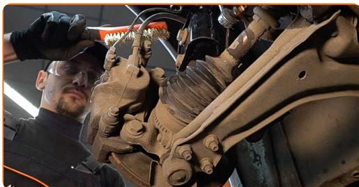
**10** Desaparafuse a fixação de pinça de travão. Use HEX n.º H6. Use uma chave de catraca.
