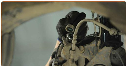
**8** Desconecte o sensor do indicador de desgaste das pastilhas de travão. Use alicates de ponta arredondada.
