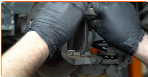
**18** Retire o sensor de desgaste da pastilha de travão. Use uma chave de fenda plana.
