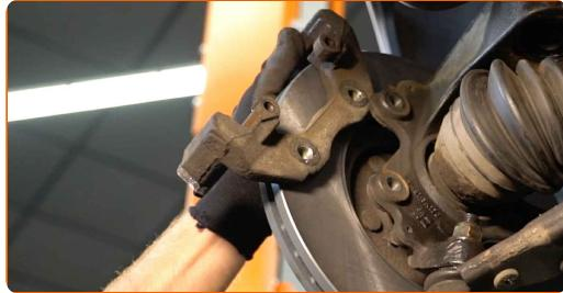
**21** Aperte a braçadeira da pinça do travão. Use uma chave soquete nº 15. Use uma chave de torque. Aperte-o para o torque de 120 Nm.
