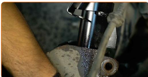
**50** Instale o parafuso de fixação. Use uma chave soquete nº 15.
