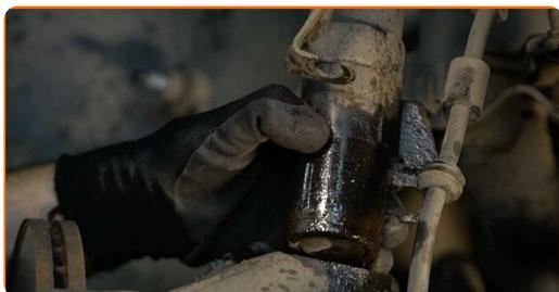
**28** Desapertar a fixação superior de montagem do suporte do amortecedor.
