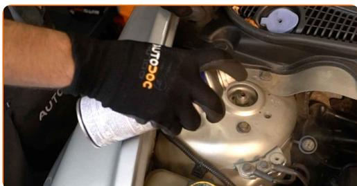
**4** Solte o fixador superior do apoio da coluna de suspensão. Use uma chave soquete nº 13. Use uma chave de catraca.
