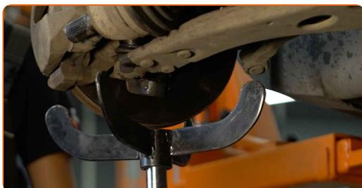
**25** Solte o fixador inferior que conecta a coluna de suspensão às mangas de eixo. Use uma chave especial para remover o amortecedor. Use uma chave de catraca.
