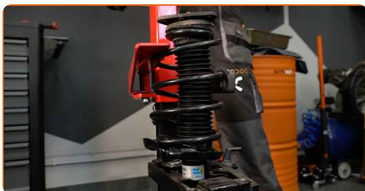
**45** Retire a coluna de suspensão montada.
