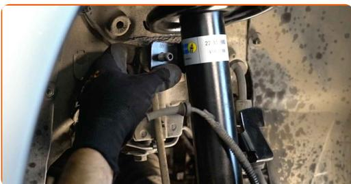
**61** Desaparafuse o fixador que conecta bieleta da barra estabilizadora à barra estabilizadora. Use uma chave combinada n.º 15. Use HEX n.º H5 Use uma chave de torque. Aperte-o para o torque de 60 Nm.
