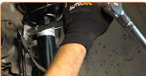
**62** Conecte a fixação do cabo do sensor ABS ao suporte do amortecedor.
