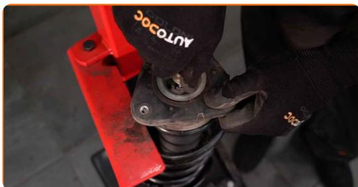
**43** Aperte a porca do suporte do amortecedor da haste do pistão. Use HEX n.º H6 Use uma chave soquete nº 18. Use uma chave de torque. Aperte-o para o torque de 50 Nm.
