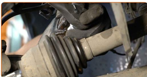
**26** Remova o parafuso de fixação.
