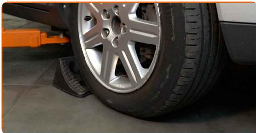
**6** Solte os parafusos de montagem das rodas. Use o soquete de impacto para roda #19.
