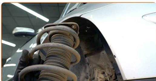
**30** Coloque o suporte do amortecedor sobre a ferramenta de compressão da mola.
