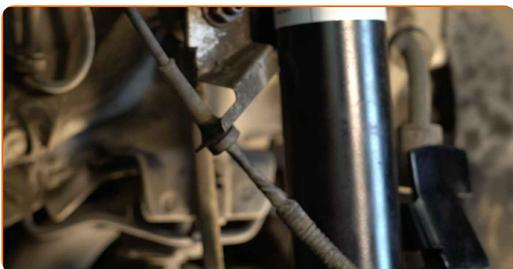
**63** Instale a aperte o parafuso do eixo de transmissão. Use uma chave soquete n.º 13.
