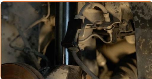
**60** Instale o terminal do estabilizador transversal.
