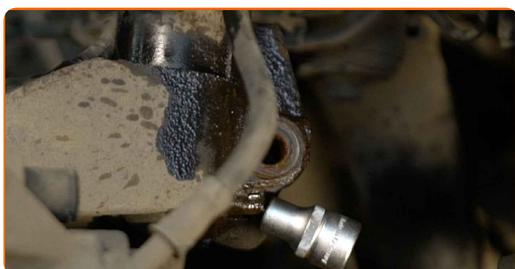
**27** Desligar a manga de eixo do suporte do amortecedor.
