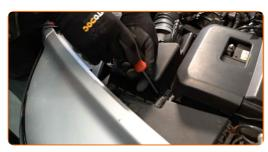
Desconecte o conector do medidor de massa de ar.
