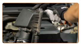
Insira um novo elemento de filtro na caixa do filtro. Certifique-se de que a borda do filtro encaixa-se perfeitamente na caixa.
