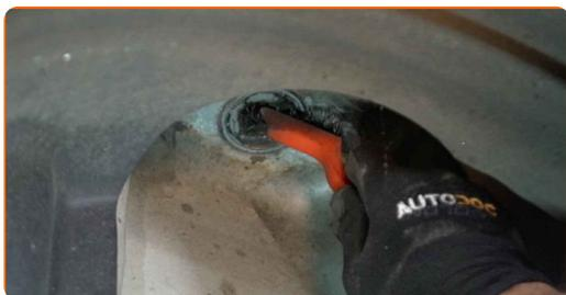
**21** Coloque o amortecedor no arco da roda e fixe-o.
