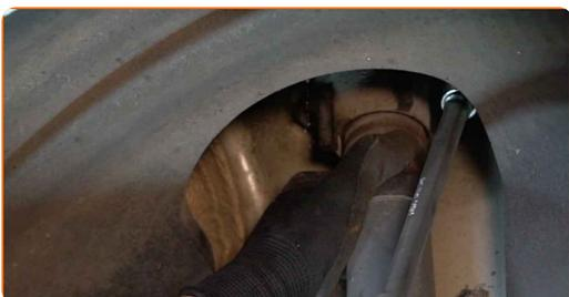
Substituição: amortecedor – VOLVO S40 II (MS, 544). AUTODOC recomenda:
