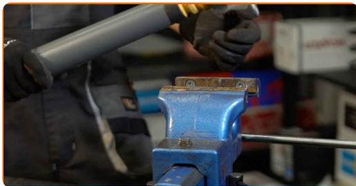
**20** Limpe os locais de montagem do amortecedor. Use uma escova metálica. Use spray WD-40.
