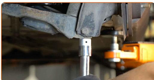
**8** Desaperte a fixação inferior do amortecedor. Use uma chave soquete nº 15. Use uma chave de tarraxa.
