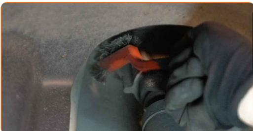
**11** Desaperte a fixação superior do amortecedor. Use uma chave soquete nº 10. Use uma chave de catraca.
