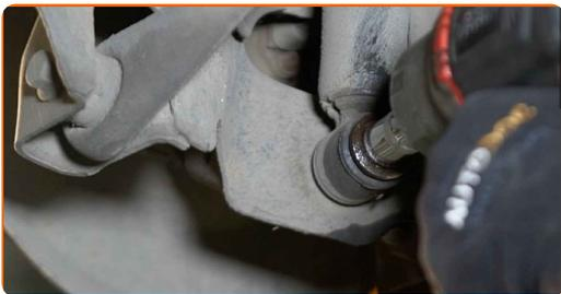
**9** Remova o parafuso de fixação.
