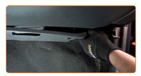
Desaperte os fixadores da tampa da caixa do filtro do habitáculo. Use Torx T20. Use uma chave de catraca.
