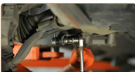
**13** Desaparafuse o fixador que conecta bieleta da barra estabilizadora à barra estabilizadora. Use uma chave combinada nº 18. Use Torx T27. Use uma chave de torque. Aperte-o para o torque de 90 Nm.
