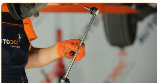
**12** Aperte o fixador que conecta a bieleta da barra estabilizadora à barra estabilizadora. Use uma chave combinada nº 16. Use Torx T30. Use uma chave de torque. Aperte-o para o torque de 50 Nm.
