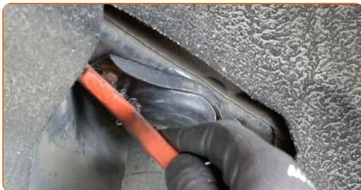
**8** Desaperte os parafusos do apoio do amortecedor. Use uma chave soquete nº 10. Use uma chave de catraca.
