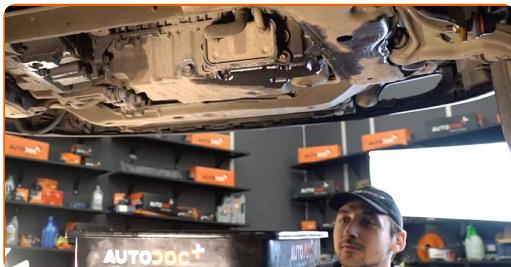
7 Desaperte o bujão de drenagem. Use uma chave combinada nº 15. Use uma chave soquete nº 15. Use uma chave de catraca.
