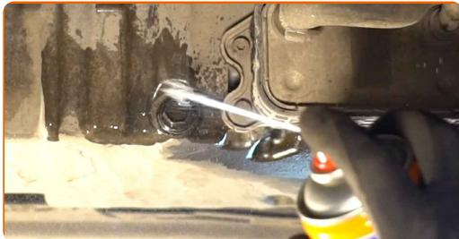
6 Coloque um recipiente de óleo usado com pelo menos 5 litros de capacidade sob o orifício de drenagem.
