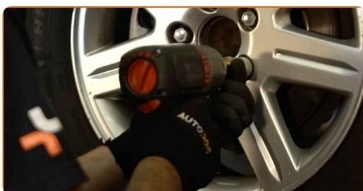
Substituição: discos de travão – VOLVO V40 Hatchback (525, 526). Conselho:
