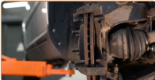
Substituição: pastilhas de travão – VOLVO V40 Hatchback (525, 526).
