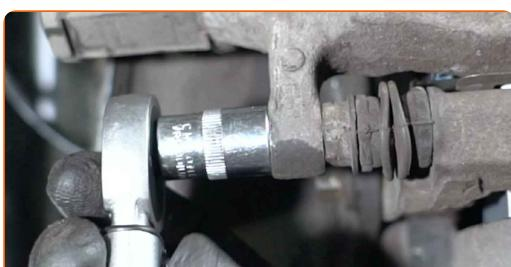
**22** Trate a superfície onde o disco de travão entra em contacto com o aro da roda. Utilize massa lubrificante de cerâmica.
