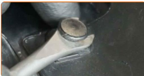
**4** Afaste a grelha do capô para aceder aos fixadores do suporte da torre da suspensão.
