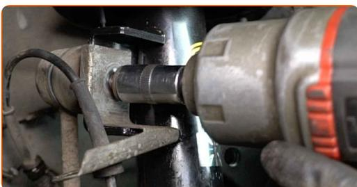
**29** Retire o tirante da barra estabilizadora da torre da suspensão.
