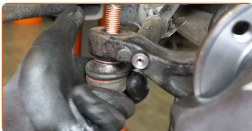
**63** Aparafuse a porca de fixação que liga o terminal de direção à manga do eixo. Use uma chave soquete nº 22. Use uma chave de catraca.
