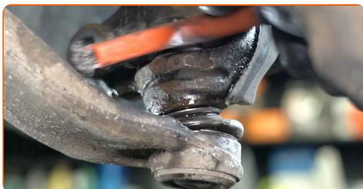
**37** Desaparafuse o fixador que liga a junta esférica à manga do eixo. Use uma chave combinada nº 21.
