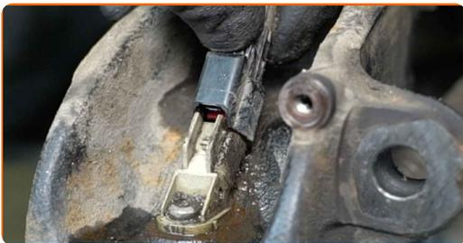
**27** Desconecte a cablagem do sensor ABS.
