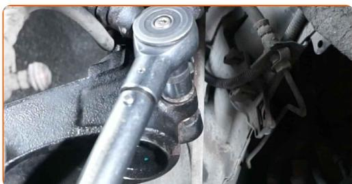
**81** Aperte os parafusos do suporte da pinça do travão. Use uma chave soquete nº 18. Use uma chave de torque. Aperte-o para o torque de 150 Nm.
