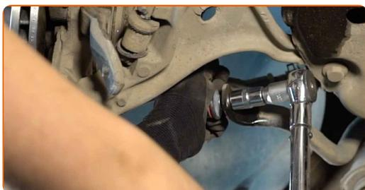
**14** Desaparafuse o fixador que conecta bieleta da barra estabilizadora à barra estabilizadora. Use uma chave combinada nº 18. Use uma chave soquete nº 18. Use uma chave de torque. Aperte-o para o torque de 50 Nm.
