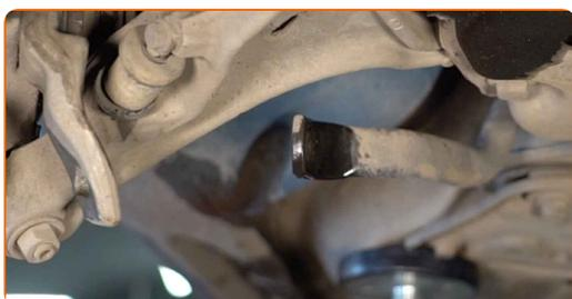
**Substituição: tirante da barra estabilizadora – VOLVO V70 I (875, 876).**
