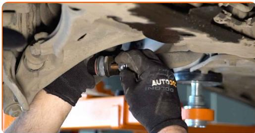
**13** Aperte o fixador que conecta a bieleta da barra estabilizadora à barra estabilizadora. Use uma chave combinada nº 18. Use uma chave soquete nº 18. Use uma chave de torque. Aperte-o para o torque de 60 Nm.
