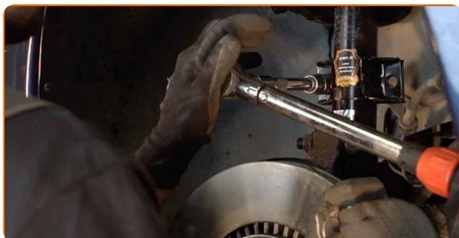
**15** Trate todas as juntas de conexão do estabilizador. Use massa de cobre.
