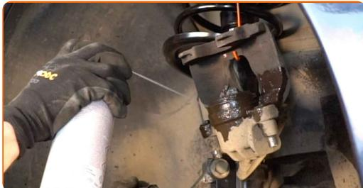
**Substituição: discos de travão – VOLVO V70 I (875, 876). Conselho da AUTODOC:**
