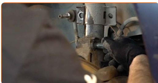
**13** Desligar a manga de eixo do suporte do amortecedor.
