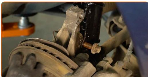
**41** Instale os parafusos de fixação.
