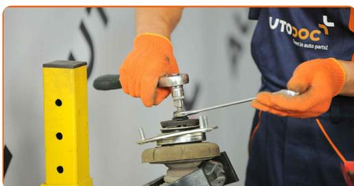
Substituição: cabeçotes do amortecedores – VOLVO V70 II (285). Conselho:
