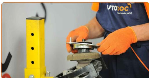
**28** Aperte a porca do suporte do amortecedor da haste do pistão. Use uma chave combinada nº 21. Use Torx T50. Use uma chave de torque. Aperte-o para o torque de 70 Nm.
