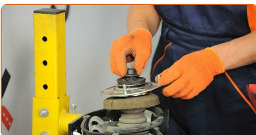
**32** Retire a coluna de suspensão montada.
