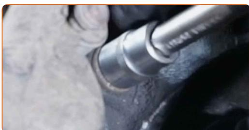
**82** Aperte o fixador que liga a junta esférica à manga de eixo. Use uma chave combinada nº 21. Use uma chave de torque. Aperte-o para o torque de 110 Nm.
