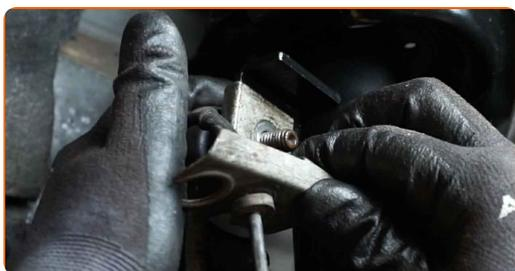
**65** Aparafuse o fixador que liga a biela da barra estabilizadora à torre da suspensão. Use uma chave soquete nº 15. Use uma chave de catraca.
