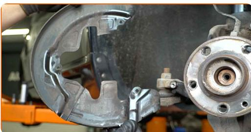
**25** Limpe o conetor do sensor ABS. Utilize uma escova de limpeza de nylon. Use o spray de limpeza universal.
