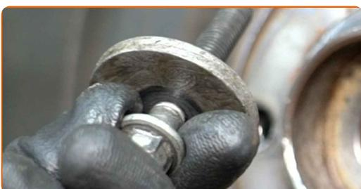
**21** Limpe os fixadores de proteção dos discos de travão. Use uma escova metálica. Use spray WD-40.
