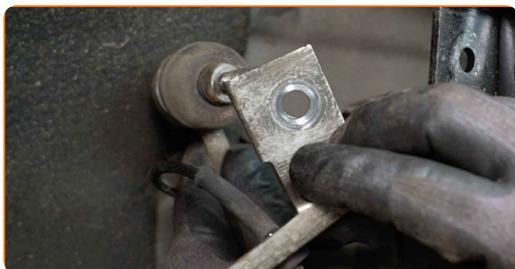
**30** Limpe o elemento de fixação que conecta o terminal de direção à manga de eixo. Use uma escova metálica. Use spray WD-40.
