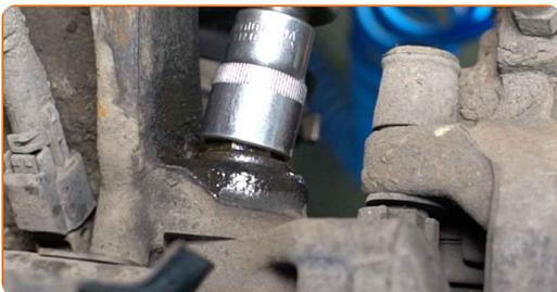
**13** Retire os parafusos de fixação.
