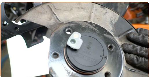
**31** Instale o novo cubo de roda juntamente com o rolamento.
