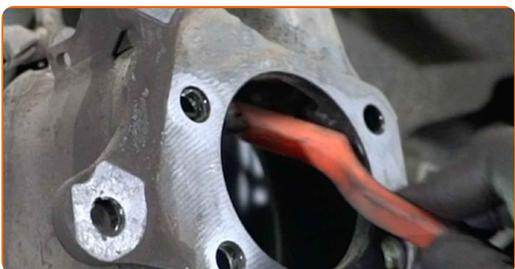
**30** Instale a proteção dos discos de travão.
