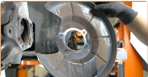
**29** Limpe o assento de montagem do cubo de roda. Use uma escova metálica.
