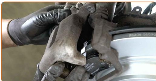
**48** Instale os parafusos de fixação.
