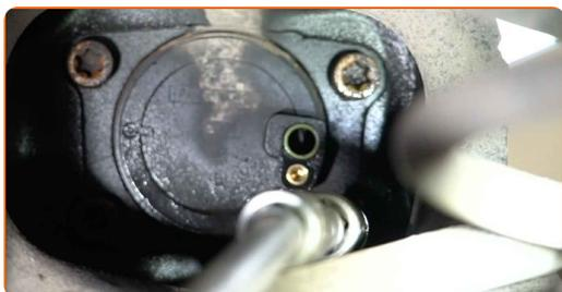
**26** Retire os parafusos de fixação.
