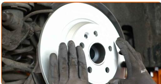
**40** Instale o parafuso de fixação.
