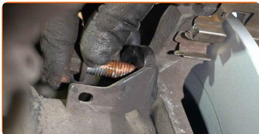
**45** Aperte os parafusos do suporte da pinça do travão. Use uma chave soquete nº 15. Use uma chave de torque. Aperte-o para o torque de 110 Nm.
