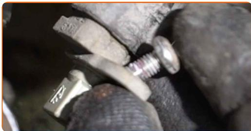
**24** Limpe os elementos de fixação do cubo de roda. Use uma escova metálica. Use spray WD-40.
