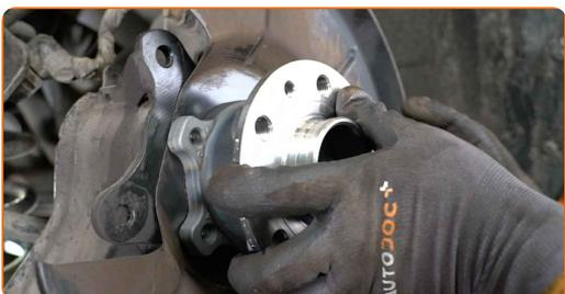
**32** Instale os parafusos de fixação.
