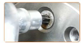
Limpe o suporte da pinça de travão para remover a sujidade e o pó. Use uma escova metálica. Utilize um produto de limpeza para travões.
