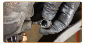
Desaperte os parafusos da pinça de travão. Use HEX n.º H7. Use uma chave de catraca.
