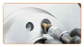
Aperte os fixadores do disco de travão. Use Torx T50. Use uma chave de torque. Aperte-o para o torque de 15 Nm.
