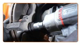
Retire os parafusos de fixação.
