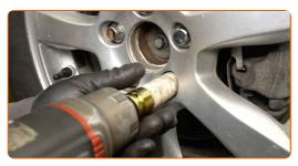
Baixar o carro e trabalhar em ordem transversal, apertar os parafusos das rodas. Use o soquete de impacto para roda #19. Use uma chave de torque. Aperte-o para o torque de 140 Nm.
