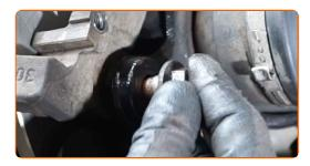
Aperte os parafusos do suporte da pinça do travão. Use uma chave soquete nº 18. Use uma chave de torque. Aperte-o para o torque de 150 Nm.
