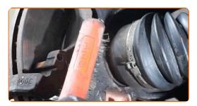
Desaperte os parafusos do suporte da pinça do travão. Use uma chave soquete nº 18. Use uma chave de catraca.
