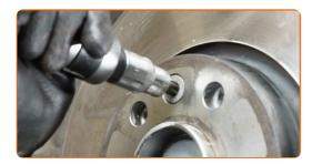
Remova o parafuso de fixação.
