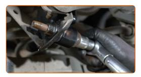
Aperte os parafusos do apoio do amortecedor. Use uma chave soquete nº 10. Use uma chave de torque. Aperte-o para o torque de 30 Nm.
