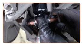
Para apertar corretamente os fixadores, é necessário elevar os componentes da suspensão à sua posição de trabalho com um macaco. Use um macaco hidráulico de caixa de transmissão.
