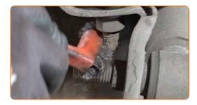
Desaparafuse os fixadores inferiores do amortecedor. Use uma chave soquete nº 18. Use uma chave de catraca.
