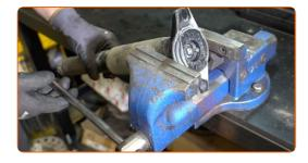
Limpe o elemento de fixação de componentes do amortecedor. Use uma escova metálica. Use spray WD-40.
