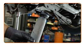
Limpe os locais de montagem do amortecedor. Use uma escova metálica.
