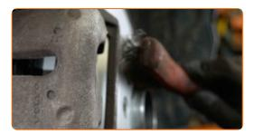
Trate a superfície onde o disco de travão entra em contacto com o aro da roda. Utilize massa lubrificante de cerâmica.
