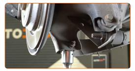
Limpe os fixadores do suporte superior do amortecedor. Use uma escova metálica. Use spray WD-40.
