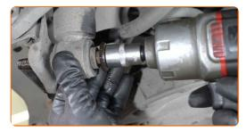
Remova o parafuso de fixação.
