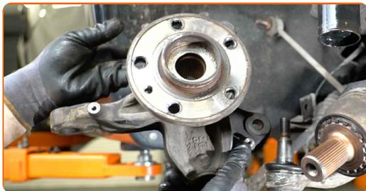
**44** Limpe o local de montagem da torre da suspensão na manga do eixo. Use uma escova metálica.
