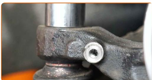
**64** Voltar a ligar o tirante da barra estabilizadora à torre da suspensão.
