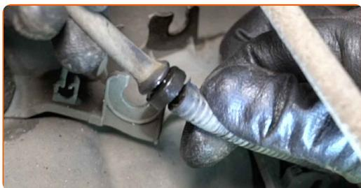
**28** Desparafuse o fixador que conecta a bieleta da barra estabilizadora à coluna do amortecedor. Use uma chave soquete nº 15. Use uma chave de catraca.
