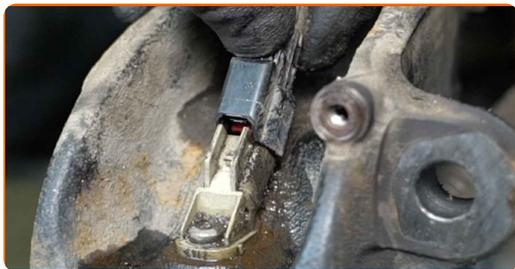
**27** Desconecte a cablagem do sensor ABS.
