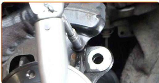
**72** Trate a superfície de contacto. Utilize massa lubrificante de cerâmica.
