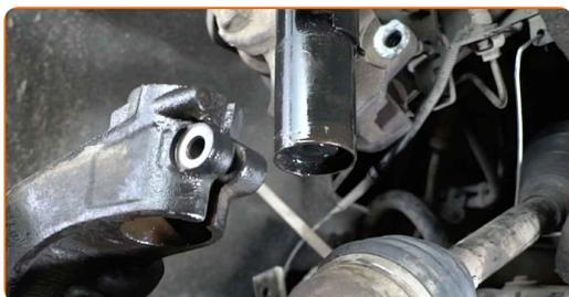
**43** Remova a manga do eixo juntamente com o cubo de roda.
