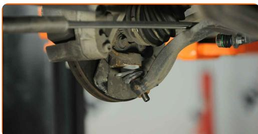
**17** Instale os parafusos de fixação.
