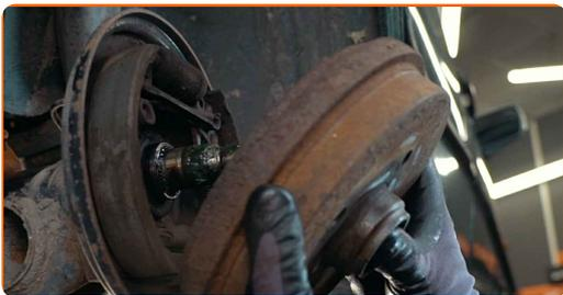
Substituição: rolamento da roda – VW 1500/1600 Variant (36). Conselho:
