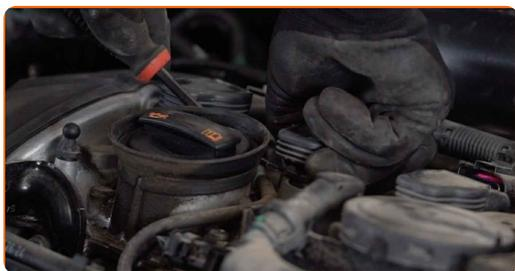
**7** Retire as bobinas de ignição dos poços das velas de ignição.
