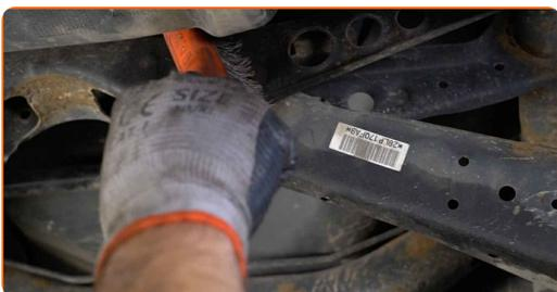
**7** Marque o parafuso de ajuste da divergência.
