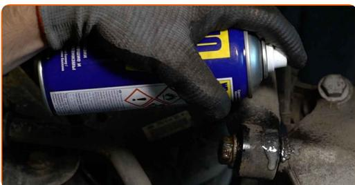
**16** Desparafuse os fixadores inferiores do amortecedor. Use uma chave soquete nº 21. Use uma chave de catraca.
