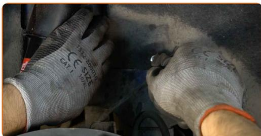
**39** Instale e aperte os elementos de fixação da cobertura do arco da roda. Use Torx T25. Use uma chave de catraca.
