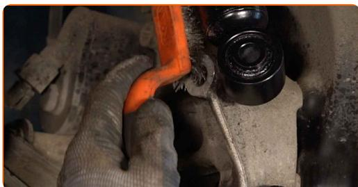
**41** Aparafuse o fixador inferior do amortecedor. Use uma chave soquete nº 21. Use uma chave de catraca.
