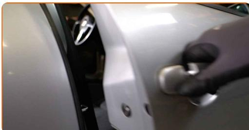
2 Desmonte o painel de acabamento do puxador da porta. Utilize uma ferramenta de acabamento de plástico.
