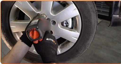
23 Baixar o carro e trabalhar em ordem transversal, apertar os parafusos das rodas. Use uma chave de torque. Aperte-o para o torque de 120 Nm.
